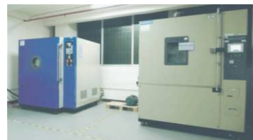
低气压测试箱（左）， 恒温恒湿测试箱（右）
