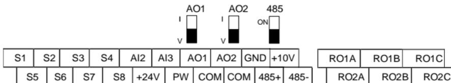
图 3-5 控制回路端子示意图
