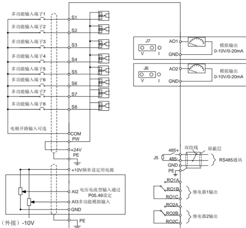
图 3-4 控制回路接线图
