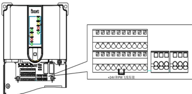
图 3-6 跳线短接位置示意图
