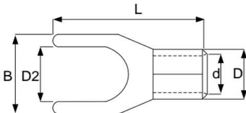
图 C-1 Y 型端子示意图
