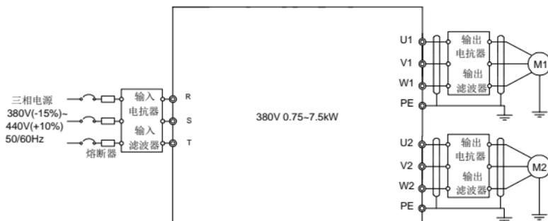
图 3-2 主回路接线图
