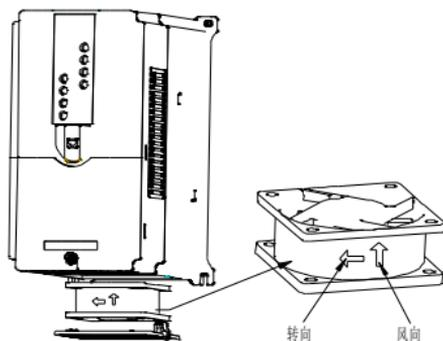
图 6-1 Goodrive18 二合一系列变频器风扇维护示意图
