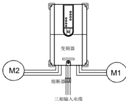
图 3-9 熔断器配置图
