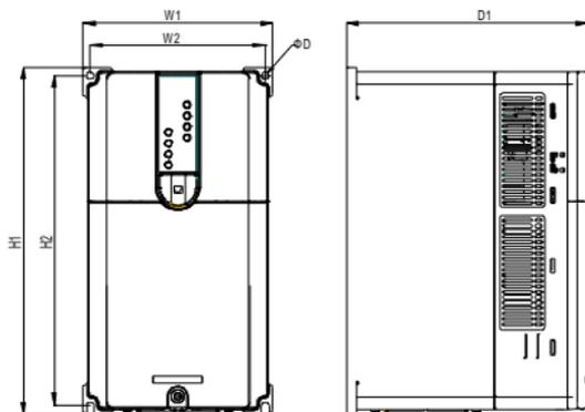
图 B-1 壁挂安装示意图
