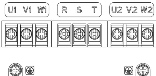
图 3-3 主回路端子示意图
