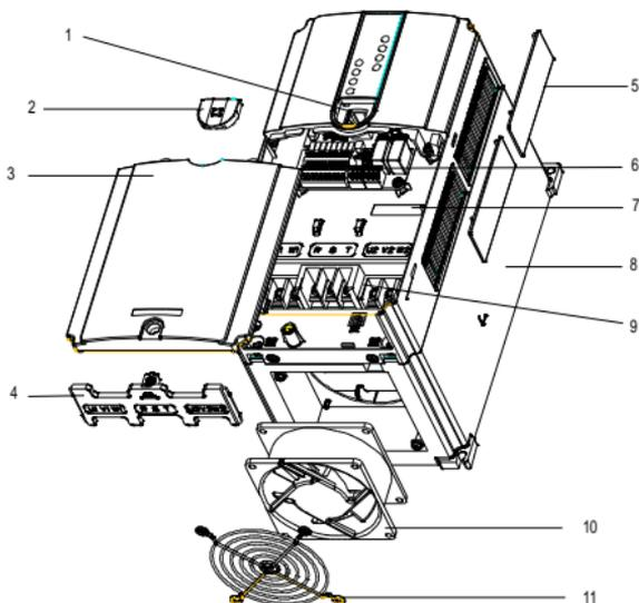
图 2-3 产品结构示意图
