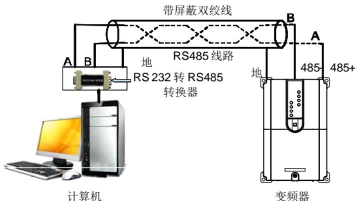
图 7-1 RS485 单机应用时的物理接线图
