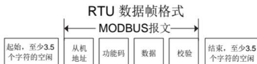
一个帧的信息必须以一个连续的数据流进行传输，如果整个帧传输结束前有超过 1.5 个字节以上的间隔时间，接收设备将清除这些不完整的信息，并错误认为随后一个字节是新一帧的地址域部分，同样的，如果一个新帧的开始与前一个帧的间隔时间小于 3.5 个字节时间，接收设备将认为它是前一帧的继续，由于帧的错乱，最终 CRC 校验值不正确，导致通讯故障。
