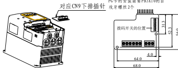
图 A-3 异步 PG 卡安装示意图及其外形尺寸
