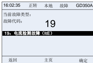
图 5-7 故障告警显示状态图
