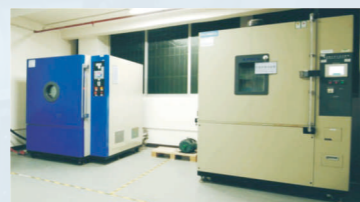
低气压试验箱(左), 恒温恒湿试验箱(右)
