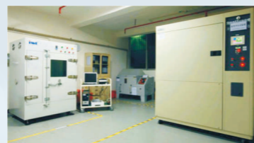
自然对流试验箱(左), 冷热冲击试验箱(右)
