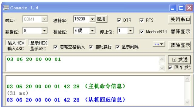
首先将“串口”选择 COM1。波特率要与 P14.01 设置一致。数据位、校验位、停止位一定要与 P14.02 中设置的一致。因为使用的是 RTU 模式，所以选择十六进制的“HEX”。要软件自动加上 CRC，一定
