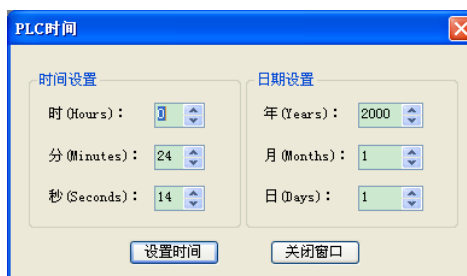
图2-20 设置 PLC 时间
