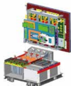
3300V三电平防爆变频器机芯
