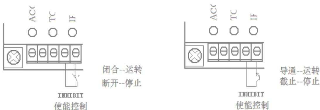
当“使能控制端”两端闭合时, 控制器内部电路会迅速(取 ACCEL 设定值)提升马达转速, 直到 MAX SPD 设定值上。当“使能控制端”两端断开时, 控制器内部电路会快速降低马达转速, 直到马达停止运转。
