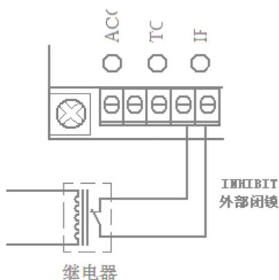
**!**注：当频繁控制电机的启动、停止时 请务必使用此端子控制。否则，可能造成设备的损坏。
