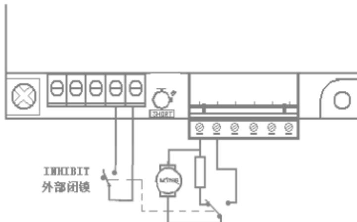
这种控制方式可获取较好的制动效果。
