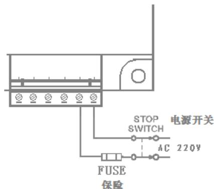
注：快速保险及电源总开关的选择：电源总开关的额定电流值要大于或等于电机额定电流的 150-200%）
