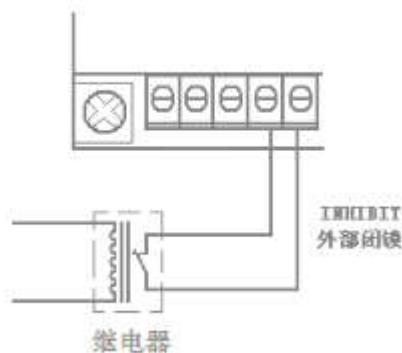
**!**注：当频繁控制电机的启动、停止时 请务必使用此端子控制。否则，可能造成设备的损坏。
