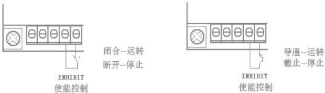
当“使能控制端”两端闭合时，调速器内部电路会迅速（取 ACCEL 设定值）提升电机转速，直到 MAX SPD 设定值上。当“使能控制端”两端断开时，调速器内部电路会快速降低电机转速，直到电机停止运转。
